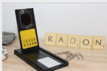
Détecteur Radon (DSTN) de type ouvert. Craint la poussière et les projections
